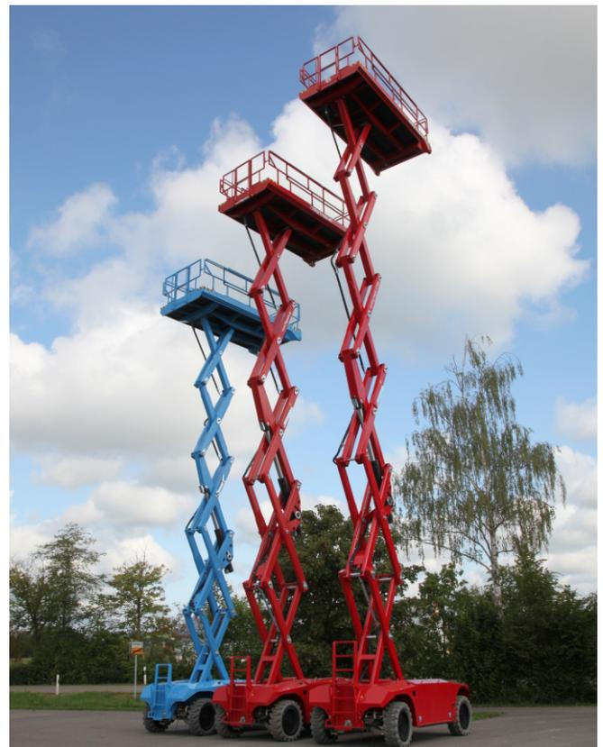
Arbeitshöhe / Working height 12.80 m - 17.80 m
